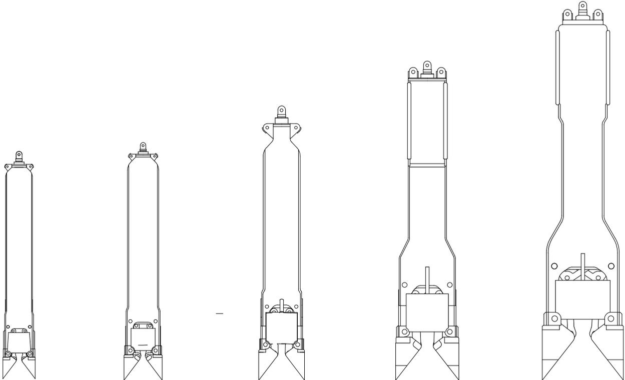
Der neu entwickelte Bohrgreifer mit der Typbezeichnung „**Volumengreifer**“ wurde insbesondere für eine Zusammenarbeit mit dem „**Kugelgreifer**“ konzipiert.
